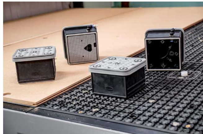
Çok yönlü VCBL, yerleştirme ve ızgara masa uygulamaları için eşit derecede uygundur.
