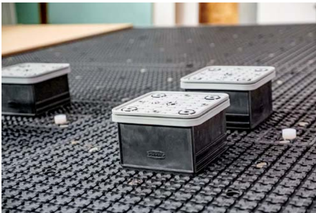
Tüm yaygın ızgara geometrileri, optimize edilmiş VCBL-R vakumlu sıkıştırma ekipmanıyla donatılabilir.
